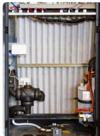
Bei den Upflow- und Downflow Versionen ist der Luftfilter parallel zum Register angeordnet und besitzt die identische Größe. Somit wird der Druckverlust des Luftvolumenstroms und der Energieverbrauch der Ventilatoren reduziert.
